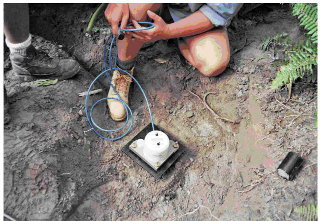
Ein Neigungsmesser ist auf der Vulkaninsel Montserrat in Gebrauch. Foto: Peter Kennett
